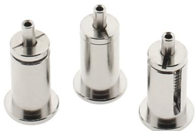
3x Conectores para atornillar al techo y sujetar el cable de suspensión (hasta 3mm de grosor) de las lámparas suspendidas. Incorpora un sistema de presa que sujeta el cable y lo puede regular con facilidad a la altura deseada.
